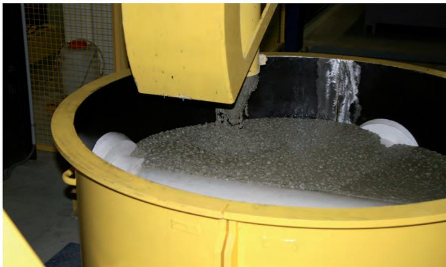
Рукав подачи бетона отвечает за оптимальное наполнение формы
