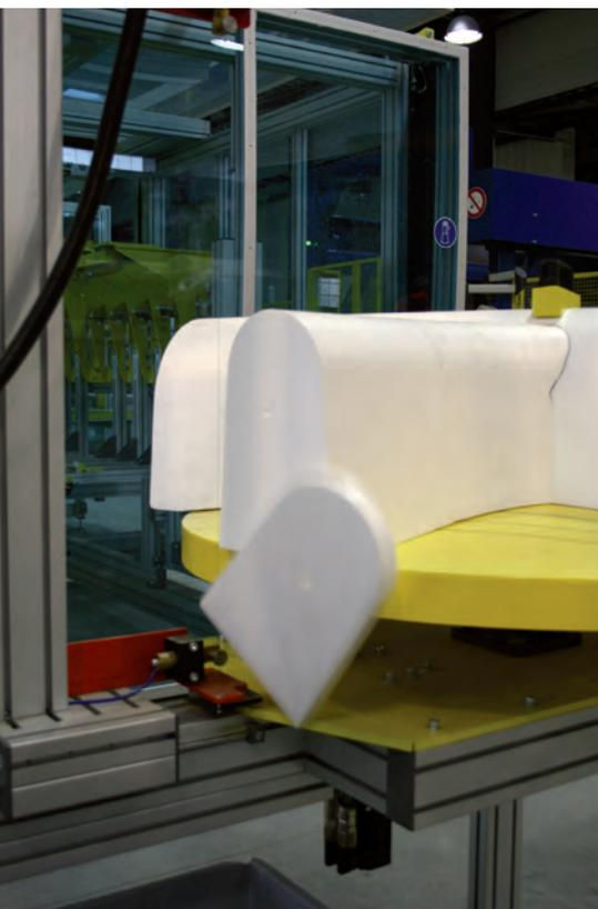
Последний чистовой рез собранной вставки-вкладыша водовода
