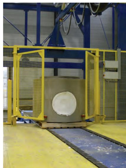
... и ставятся на ленточный конвейер, который отвозит их на последнюю станцию обработки, где из них удаляются детали из пенопласта.
