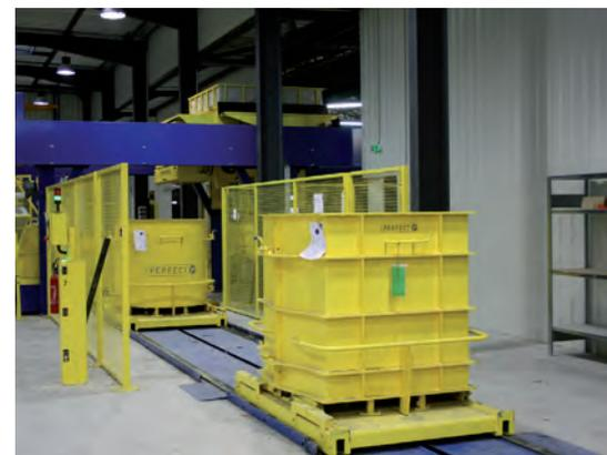
Готовые формы автоматически подаются на станцию заливки бетона
