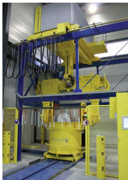
Набравшие прочность кольца с дном вынимаются из предварительно открытых форм при помощи захвата,...
