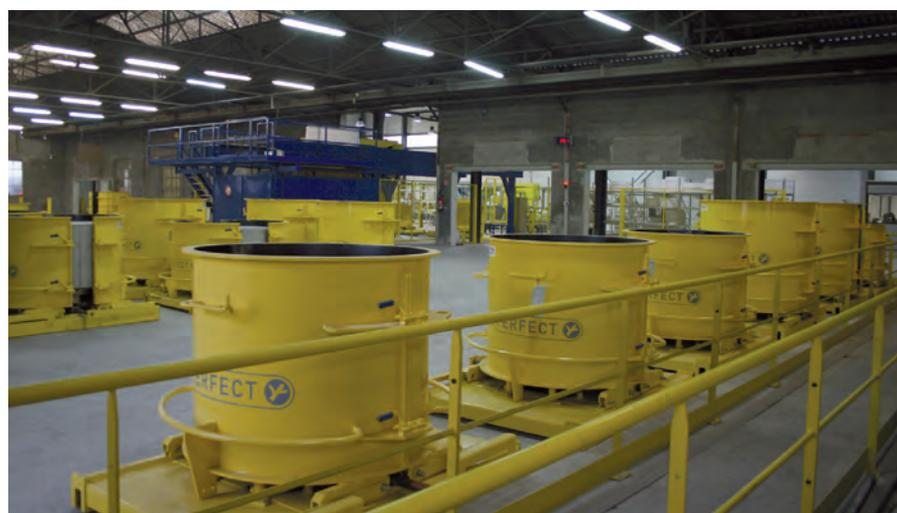
Свежезаполненные формы транспортируются с помощью отвозящей тележки на склад
